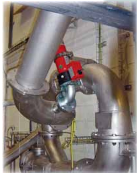
Supresor de explosión (por gentileza de Riera Nadeu).
