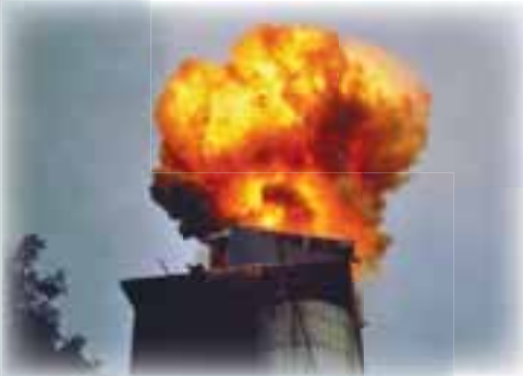
Explosión experimental realizada por el profesor Rolík K. Eckhoff y su equipo en silo de 500 m 3 en Boge, Vaksdal, Noruega.
