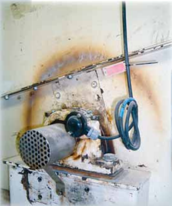
Efecto de calentamiento por patinado de la correa.
