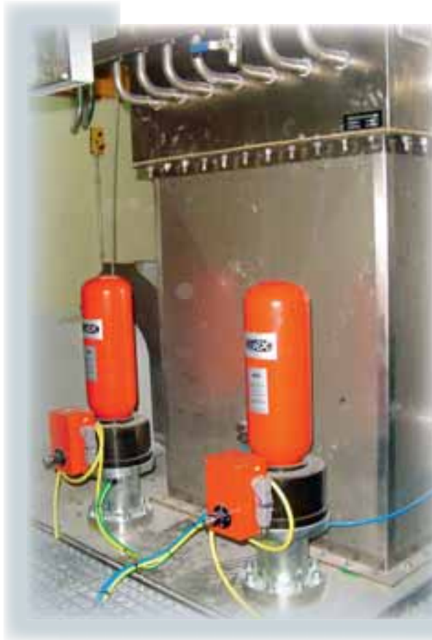
Molino de azúcar protegido con supresión de explosiones (por gentileza de Abbott Laboratories).
